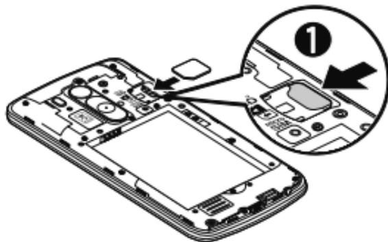
**3** Batériu vložte na miesto, zarovnajte pritom zlaté kontakty telefónu a batérie a batériu (1) jemne zatlačte, aby zapadla do príslušnej polohy (2).
